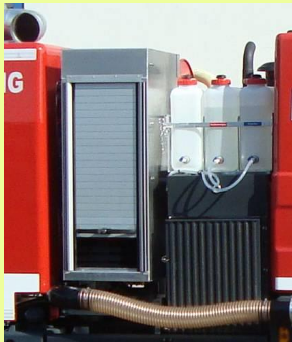
Aufbewahrungsbox für Zusatzgeräte und Vorratsbehälter für Reinigungsmittel
