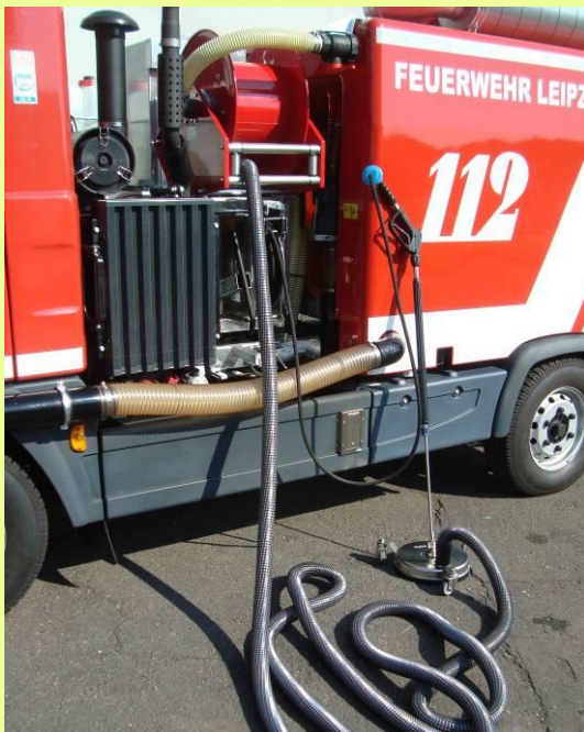
Handlanzensystem ausziehbar, 10m Aktionsradius
